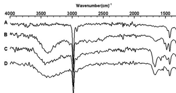
Fig. 4 FTIR spectra of (a) PDMS, (b) PDMS-NH<sub>2</sub>, (c) PDMS-NH-CMC, and (d) PDMS-NH-CMC-GEL.
